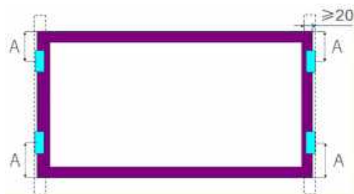
Použijte 4 upínky na kratší straně. Montážní lišty probíhají kolmo k rámu na delší straně. Délka přesahu montážních lišt a kratší strany panelu (v kolmém směru na kratší stranu) nesmí být menší než 20 mm.
