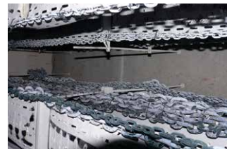
Prostor pece fy FIRES po zkoušce žlabů EKZS, r.2012
