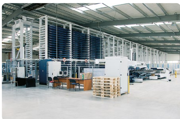
automatizovaný sklad plechů a polotovárů
