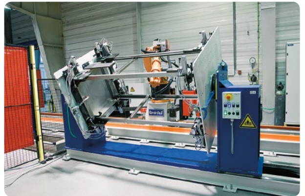
robotické svářecí pracoviště stojanových rozvaděčů
