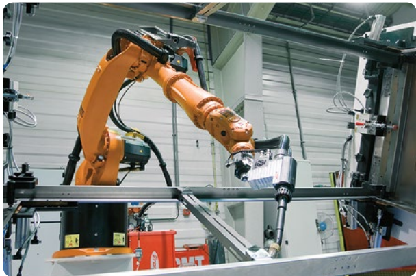
robotické svářecí pracoviště stojanových rozvaděčů
