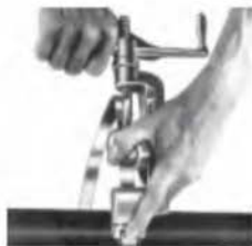
4. Při stahování pásu držte ukazováček tak, aby jste se dotýkali současně spony a pásu. Jakmile ucítíte při stahování pásu, že pás se přestává posouvat sponou, bylo dosaženo max. stažení.
