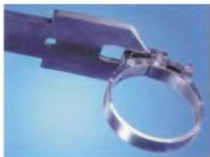
Nástroj pro jednoduché rozdělování WH spon - typ/obj. č. RT
