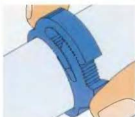
1. spona se nasadí na hadici a lehce se stáhne rukou, aby spona držela
