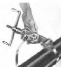
3. Přetáhněte pás šátekbinou v přední části kleští a upevňovacím zámkem. Palcem přitlačte páčku upevňovacího zámku a zaškněte stahovat pás otáčením stahovací kliky kleští. Po skončení stažení pásu není třeba dále přitlačovat páčku upevňovacího zámku, protože pás drží díky pružnosti.
