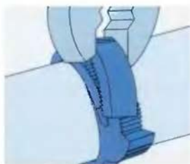
3. sponu lze kdykoliv demontovat a znovu použít
