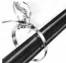
2. Obtáhněte pás okolo předmětu, ke kterému bude pás připevňován. Znovu přetáhněte pás sponou a konec pásu zaškněte pod sponu dle obrázku (min 5 cm). V případě, že je vyžadováno extrémní pevnost pásu, je možno pás obtáhnout okolo předmětu dvakrát. Dvojčím obtáčením se dosáhne skoro 4-násobné pevnosti než při jednoduchém obtažení.
