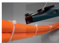
3) automatické zastřížení pásku
