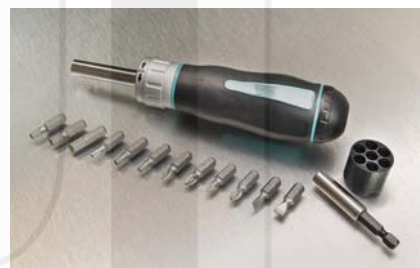
otočnou spodní částí rukojeti lze přepínat směr ráčny nebo ráčnu uzamknout
