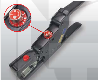
nastavení dle průměru odizolovávaného vodiče
