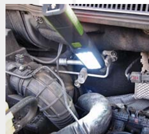
ukázka ukotvení LED lampy pomocí magnetů
