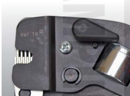
poloha páčky pro rozsah krimpování 0,08 - 10 mm 2
