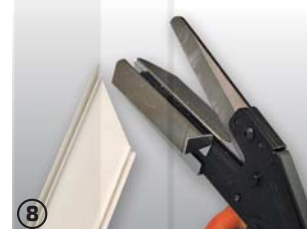
7 ustřížení úhlu 45° krytu lišty střížením podle rýsky na opěrné ploše nůžek
