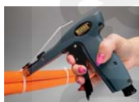
1) nasazení kleští na vázací pásek
