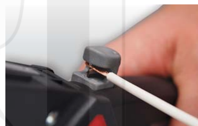
zastříhávání nebo stříhání Cu lanek do 2,5 mm
