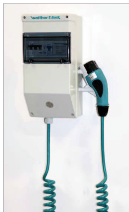
E-BoxX až 16 A s pevným spirálovým nabíjecím kabelem a spojkou typu 2; Obj. č. 6E987701 FI/LS 16 A, LS 6 A, stykač, CC2 (PWM)
