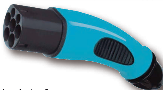
Nabíjecí zásuvka typ 2 úhlová, se šroubovými přípojkami, IP 44 v připojeném stavu, úhel sklonu 30°
