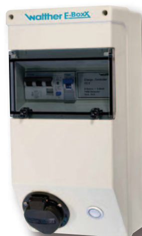
E-BoxX až 32 A s nabíjecí zásuvkou typu 2 Obj. č. 6E9877AB FI/LS 32 A, LS 6 A, stykač, CC2 (PWM)
