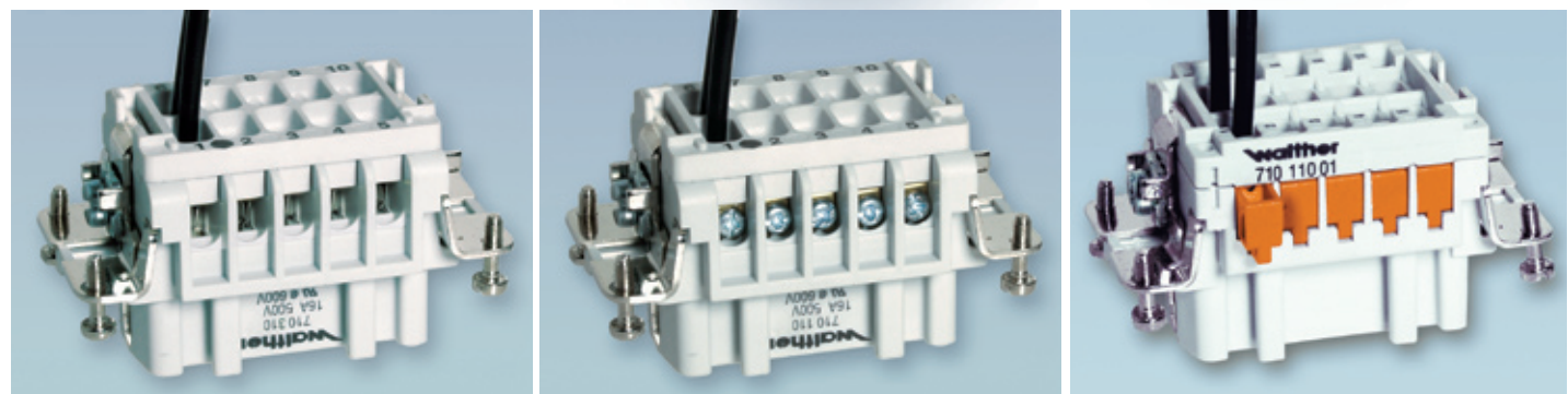
Vložka s lisovacími kontakty 0,5 – 4 mm 2 Vložka se šroubovými kontakty 0,5 – 2,5 mm 2 šroubová mechanika: Pozidrive PZ 1 Vložka s bezšroubovými kontakty (technika samořezných svorek) 0,5 – 2,5 mm 2
