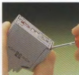
Otvírání elektronického modulu
