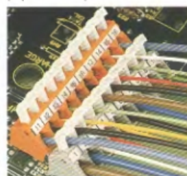
Ukázka připojení vodičů při šachovnicovém uspořádání svorkovnic
