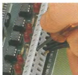
Připojení vodiče – řada 236
