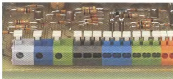
Ukáзка svorkovnice složené ze svorek pro 1 a 2 vodiče
