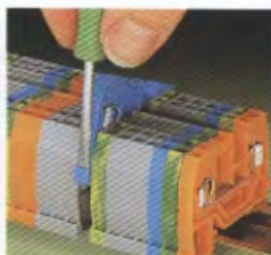
Demontáž svorky z nosné lišty.
