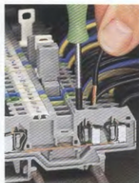
1977 Čelní propojování: systém umožňující montérovi dobrou orientaci při propojování
