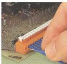
Připojení vodiče – řada 235, s uvolňovacím tlačítkem
