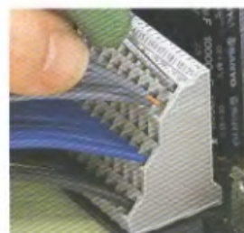
Vysoká hustota připojených vodičů při vícepatrových svorkovnicích
