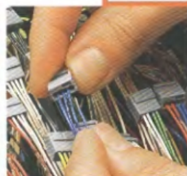
Připojení: odizolovaný vodič nasuneme do svorky
