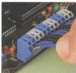
Připojení vodiče – řada 254
