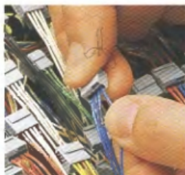
Demontáž: tahem vodiče a současným otáčením svorky sem a tam vodič odpojme
