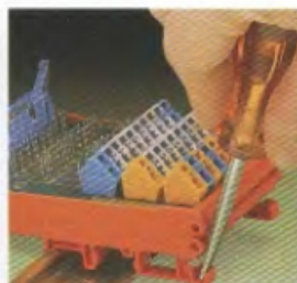
Demontáž modulu z nosné lišty
