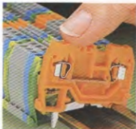
Nasazení na nosnou lištu Svorka pro ochranný vodič zajišťuje automaticky přímý kontakt na lištu.
