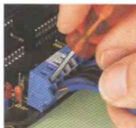
Odpojení vodiče – řada 254
