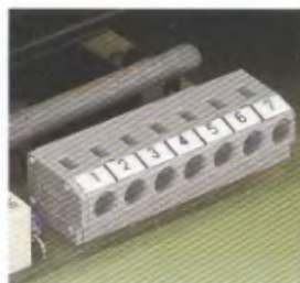
Označení svorkovnice samolepicím páskem
