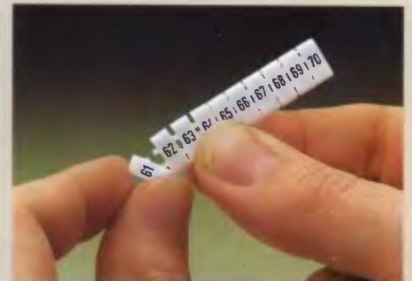
Trennen eines Einzelschildchens vom Streifen, für Klemmenbreiten über 8 mm
