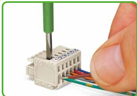
Připojení vodiče pomocí šroubováku (2,5 × 0,4) mm. Ovládání v pravém úhlu vůči směru připojení vodiče.
