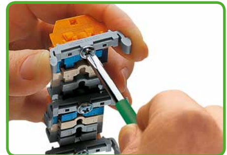
Svorkovnice s upevňovacími přírubami, našroubování montážní patky 209-123 (vzdálenost mezi jednotlivými montážními patkami pod svorkovnicí by měla činit asi 35 - 40 mm.)
