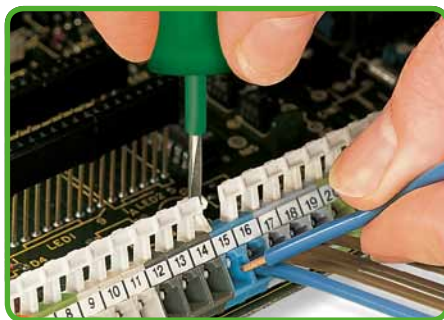
Připojení / uvolnění vodiče, řada 256
