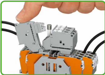
Před výměnou pojistky vyklopte držák pojistky do koncové polohy (aretace)
