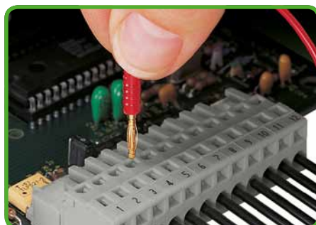
Konektor s připojením CAGE CLAMP® Zásuvná zkušební odbočka v pravém úhlu vůči směru připojení vodiče se zkušební hrotem Ø 2 mm nebo Ø 2,3 mm.
