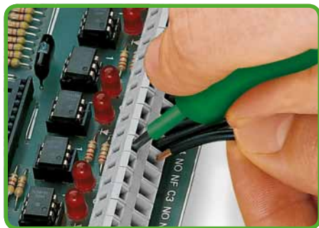
Připojení vodiče – pomocí šroubováku 3,5 mm. Ovládnání a přívod vodiče ze stejného směru.
