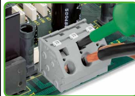
Připojení vodiče – pomocí šroubováku 5,5 mm.
