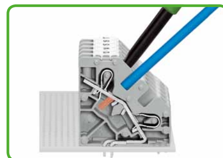
Připojení jemně laněných vodičů pomocí šroubováku 5,5 mm.
