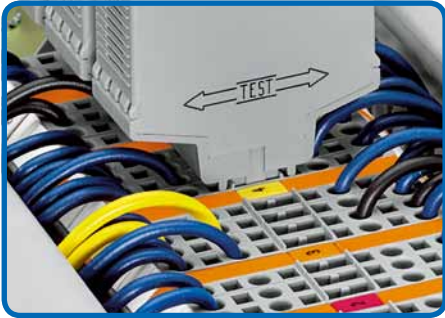
U čtyřvodičových základních svorkových bloků – dvě svěrací místa na každé straně svorky, pro snadné propojení vedení nebo jako rezerva.
