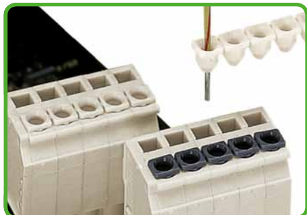
Izolační zarážka zabraňuje tomu, aby se izolace vodičů o malém průřezu dostala do kontaktního místa.
