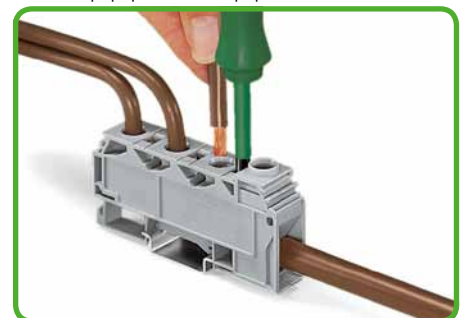
Přípojení vodiče 10 mm 2 Přípojení CAGE CLAMP®, čelní zapojení
