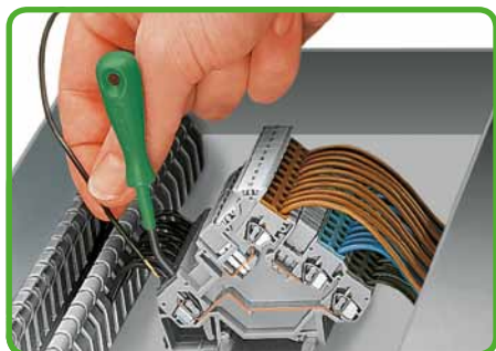
Připojení vodiče pomocí zahnutého šroubováku (3,5 × 0,5 mm).
