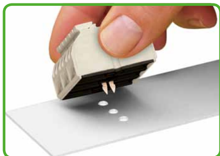
Přímé vytvoření kontaktu mezi PE kontaktem a montážní deskou. Automatické proříznutí případné lakované vrstvy
