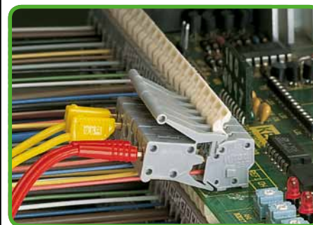
Zkoušení zkušebními adaptérem
