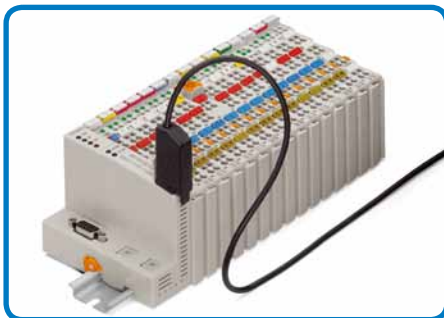
Přístup k programovacímu rozhraní Programování procesorového modulu. WAGO-I/O-CHECK, WAGO-I/O-PRO CAA
