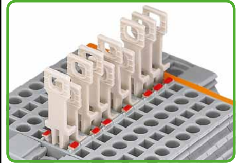
Rozpojení vytažením rozpojovací vidlice (červená viditelná = rozpojená poloha)
