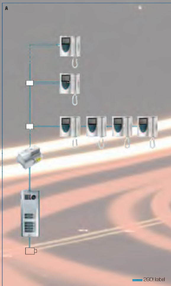
A systém videotelefonu s 1 vstupem a paralelním zapojením monitorů
