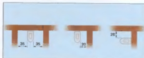
Minimální vzdálenosti pro instalaci svítidla
