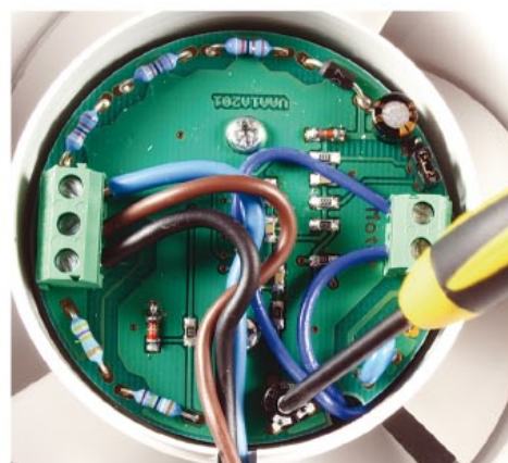
zapojení elektroniky časového spínače
