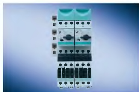
Napájecí systém je vhodný rovněž pro přímé spouštěče do 25 A (velikost S0), jistič se stykačem jsou připevněny a propojeny montážním modulem, např. 3RA1921-1AA00
