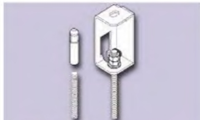
Kabelový žebřík: Upevnění závitové tyče pod stropem
