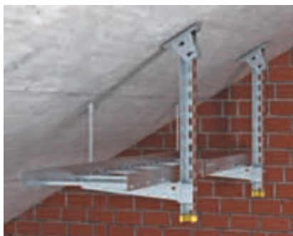
Montáž pod šikmým stropem Výklopná hlava závěsu pro úhly do 30° montovaná pod šikmým stropem.
