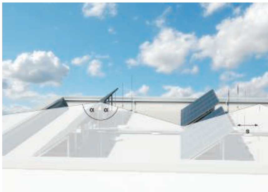
Obr. 2: \alpha^\circ = úhel ochrany před bleskem
