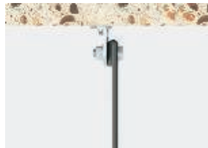
Zatěžovací stav 3: našroubován na ploché závěsy, konec pásu zdvojený, vnitřní konec pásu volný Minimální mezní zatížení dle sloupce A
