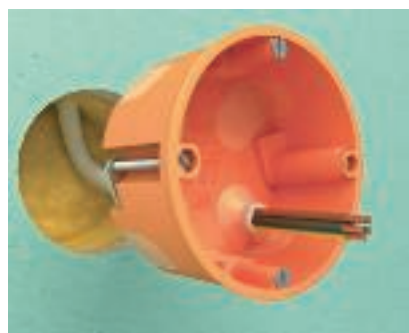
Utěsnění zavedených vedení Vedení a/nebo trubky přesně utěsní těsnicí membrána. Díky tomu nebude moci z vestavných přístrojů unikat žádný vzduch.
