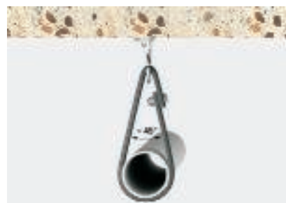
Zatěžovací stav 6: pás omotaný okolo plochého oka a trubky apod. Minimální mezní zatížení dle sloupce 2xB
