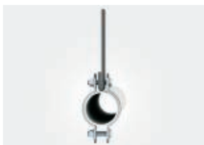
Zatěžovací stav 10: konec pásu našroubován na trubkovou příchytku, konec pásu zdvojený Minimální mezní zatížení dle sloupce A
