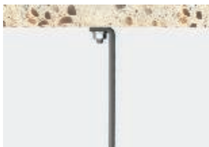
Zatěžovací stav 4: našroubovaný pomocí šroubu a podložky pod strop Minimální mezní zatížení dle sloupce C
