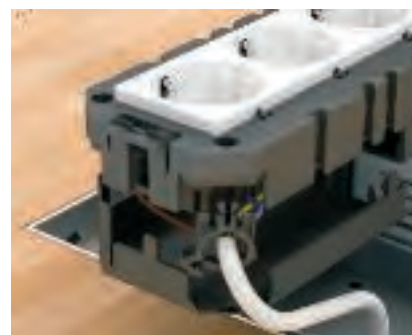
Odlehčení tahu při montáži nosiče modulu Vsadte odlehčení tahu zespodu do nosiče modulu, vložte připojovací vedení a zavřete odlehčení tahu.
