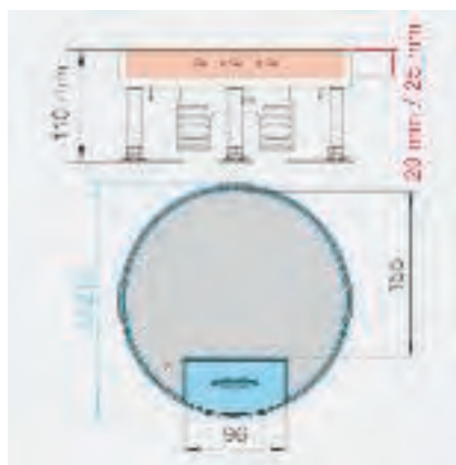
RKSR 2, se šňůrovým vývodem, jmenovitá velikost R4
