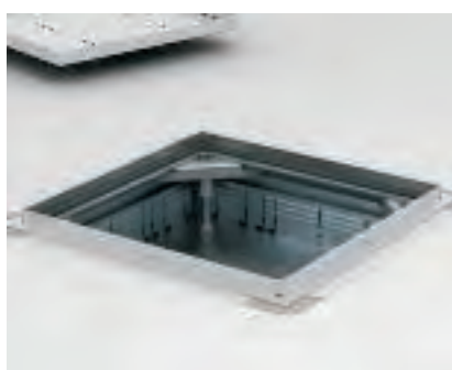
Montáž podpěry víka pro vysoká zatížení Čtyři podpěry víka pro vysoká zatížení vložte do rohů podlahové krabice a nastavte je na potřebnou výšku. Opěrný šroub zajistěte kontramaticí.
