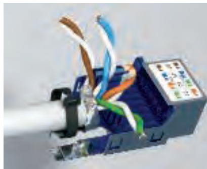
Připojení přístroje – odlehčení tahu Zasuňte kabel do úchyty a proveďte odlehčení tahu pomocí přiložené kabelové pásky. U stíněných kabelů dávejte pozor, aby byla kontaktní příložka propojena se stíněním.
