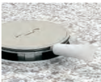
Čištění těsnění Montážní práce dokončíte vyčištěním vnitřku kazety a dále těsnění kazety a tubusu. Těsnění ošetřete vazelinou (součástí dodávky).
