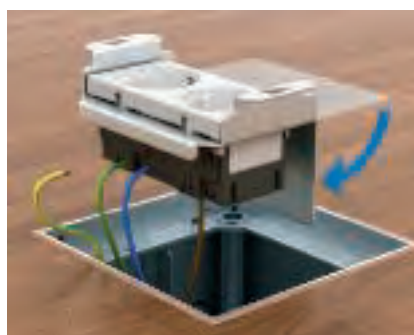
Montáž zásuvky do nosiče Naklápnete zásuvku do kovového nosiče a připojte ji. Po připojení vedení PE ohněte kovový nosič o 90 stupňů.
