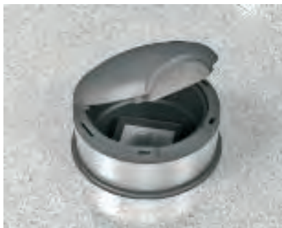
Vývod vedení pro podlahu s mokrou údržbou Ochranný kryt SHF80(M) vytváří potřebnou minimální vzdálenost od vývodu vedení k povrchu podlahy. Směr výstupu otvoru šňůrového vývodu lze zvolit libovolně.
