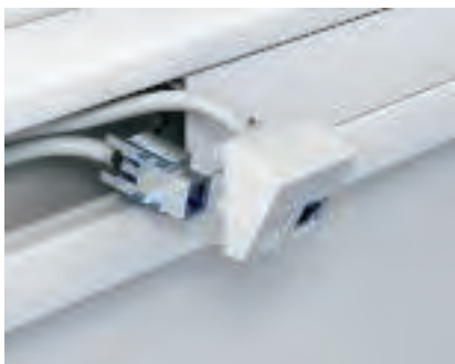
Vestavba přístroje do nosiče datové techniky Hotový připojovací modul datové techniky vložte zezadu do nosiče datové techniky. Za tímto účelem zasuňte a zaklapněte do úchyty nosnou desku připojovacího modulu.
