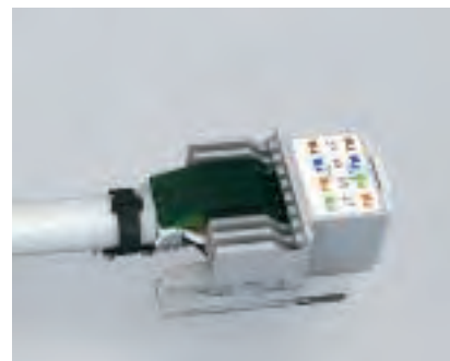
Připojení přístroje – telefonní zásuvka RJ-11 Při využití jako zásuvky pro připojení telefonu, zapojte jen vnitřní připojovací body. Nechtěnému zapojení konektorů RJ-45 do telefonní zásuvky zamezíte pomocí redukčního rámečku (typ DMZ-RR/RJ-11).
