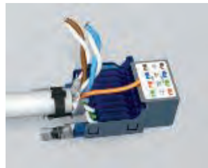
Připojení přístroje – roztrídění vedení Uložte jednotlivé žíly dle připojovací tabulky a zajistěte je kontaktní svorkou.
