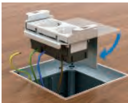
Montáž zásuvky do kompletní jednotky GE2V Přístroj Modul 45 před připojením vedení nasklapněte do kovového nosiče.
