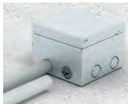
Připojení instalačních trubek Přiveďte potrubí M25, hloubka vstupu smí činit max. 5 mm.
