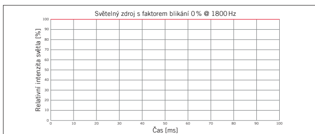
Výsledek měření svítidla s faktorem blikání 0 %
