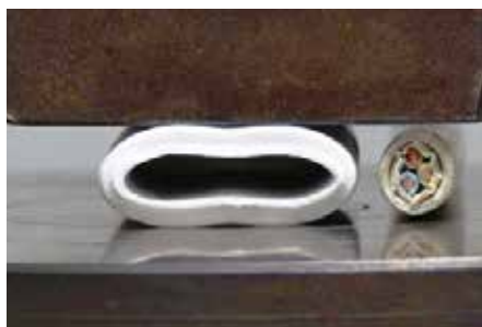
Deformace 50 % „ohebná, elastická, vrací se do původního tvaru“
