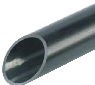
VDE 0605 DIN EN 61386-21 Minimální tlaková pevnost: 1 250 N / 5 cm
