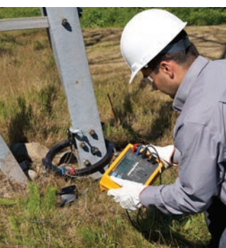
Upínací příslušenství transformátoru pro měření zemní smyčky na stožárech.
