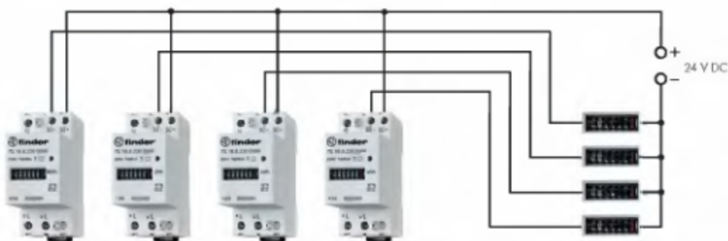
decentralně umístěné elektrůměry
