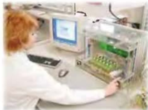
9) Po nezbytném testování ve fyzii polotovaru na jehlkových testerech (obr. 9) se provádí sestavení a následná kompletace výrobku do krabičky. V průběhu celé fyzie výroby je aktuální stav zpracovavenosti sledován pomocí žárových kódu (obr. 10).
