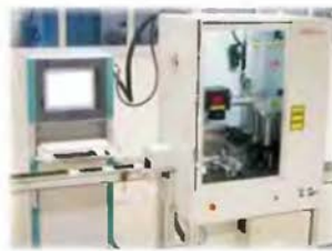
12) Nakonec jsou výrobky celoplošně optičtými laserovou technologií. Laser dokáže vypalovat z horní části (bočníka výrobku) a z boční části (přední panel a svorky). Pátek jednoho kusu trvá přibližně 30 s.
