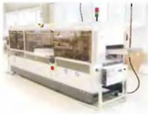
8) Po ručním dosazení klasických součátek následuje pájení na pájecí lince SEHO 8135-PCS, která již podporuje technologii pájení "lead free". Díky moduluárnímu IR pínáohřevu dovoluje pájecí linka zpracovávat DPS s teplotně citlivými součáskami na horní straně DPS. Pájecí linka je vybavena UV pájecí tryskou a Delta tryskou. Tyto umožňují kvalitní pájení součátek miniaturních rozměrů.
