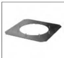
JPA adaptér pro připojení klapky JCA, volné příruby JBR, pružné spojky JAE n = počet svorníků (je shodný s počtem otvorů v ostatním příslušenství) závit je do velikosti 300 M6 do velikosti 560 M8 do velikosti 1100 M10
