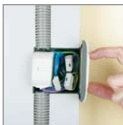
Aktor může být instalován bez problému do krabice v blízkosti bezdrátového tlačítka
