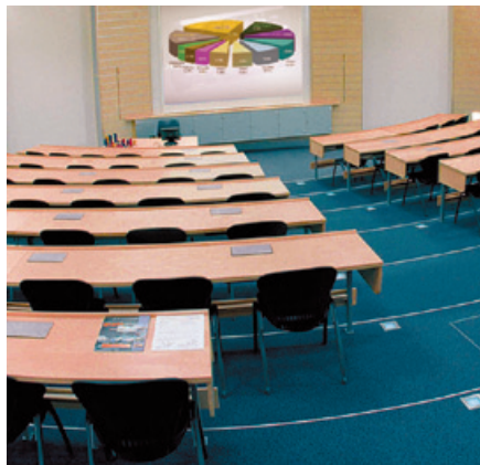
CONI umožňuje volný a individuální přístup k napájecím, mediálním a datovým přípojkám. Díky kartáčovému těsnění krytu jej lze zavřít i s připojenými kabely, aniž by došlo k jejich uskřípnutí.
